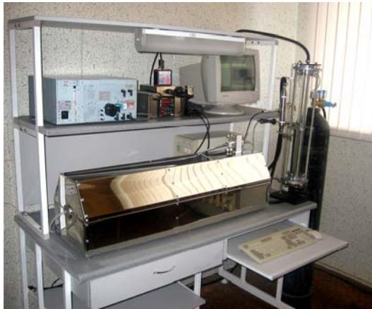
Рис. 38. Общий вид стенда для исследований гидродинамических и каталитических свойств блочных носителей и катализаторов
