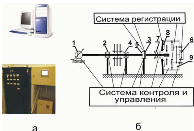
Рис. 7. Система контроля и управления стенда УЛИС:
