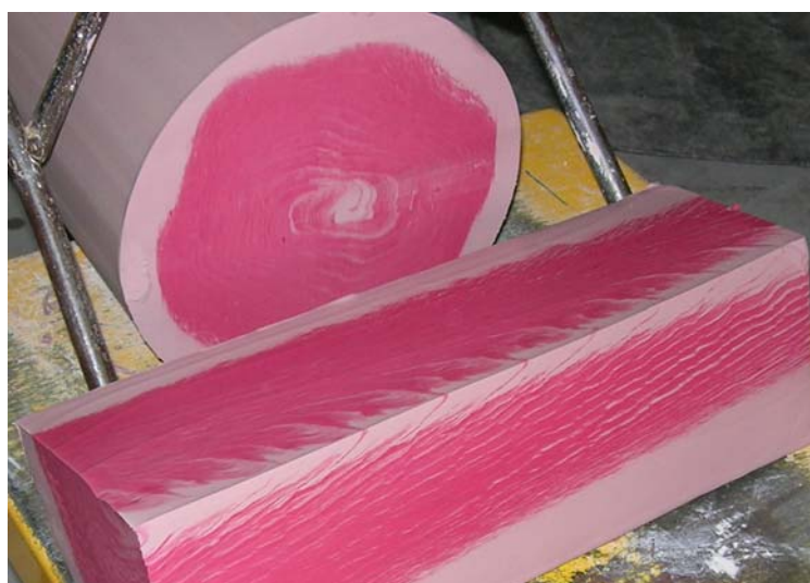
Рис. 9. Структура материала, вытянутого по новой технологии на прессе \varnothing 350\text{мм} .
