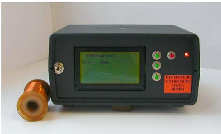
Рис. 4. Прибор ИНТМ-1 для бесконтактного контроля натяжения стальных тросов
