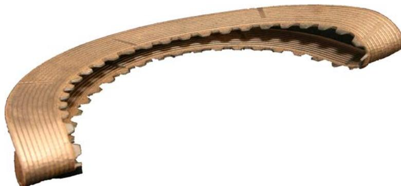
Рис. 8. Фрикционный диск трактора Т-150 с паяным с двух сторон фрикционным слоем после испытаний на прочность соединения
