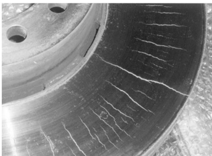
Рис. 1. Термоусталостное разрушение тормозного вентилируемого диска, работавшего в паре с тормозными накладками на полимерной основе
