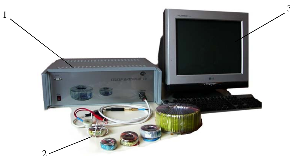
Рис. 4. Общий вид диагностического прибора ТВ 1- электронный блок; 2 - гибкая измерительная катушка и контролируемый тороидальный трансформатор; 3 - ЭВМ.
