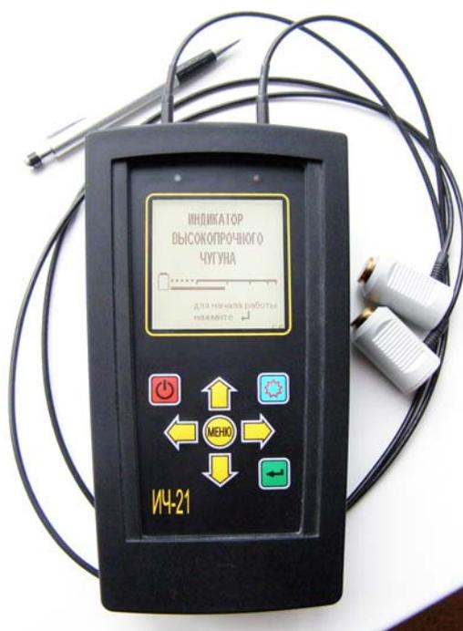
Рис. 2. Индикатор высокопрочного чугуна ИЧ-21
