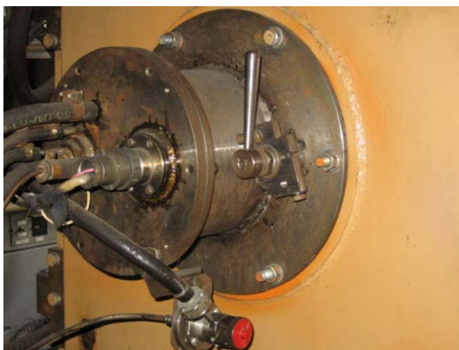
Рис. 9. Размещение фланцевого ионного источника «Аида» на камере установки вакуумного напыления ННВ-6.6-И1
