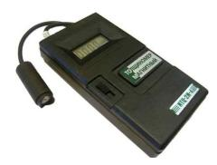
Предназначен для измерения толщин немагнитных покрытий (хром, медь, краска и др.) в диапазоне 0-5000 мкм на стали, никелевых покрытий в диапазоне 0-100 мкм
