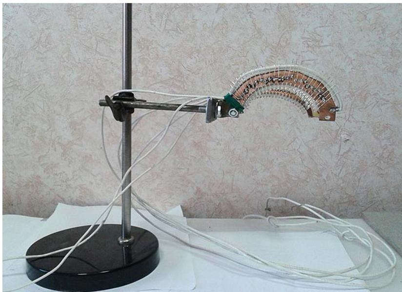
Рис. 2. Устройство для подсветки зоны при люминесцентном контроле на основе плат, содержащих по 25 фиолетовых светодиодов
