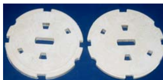
Рис.21. Детали золотниковой пары системы пневмопривода тормозов автомобилей, полученные методом СИМ из смеси на основе Al_2O_3
