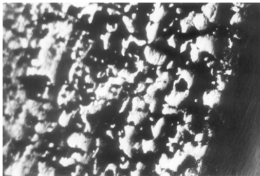
Рис. 1. Микроструктура зерен хромосилицированного слоя на поверхности порошковой стали 60. Диффузионный слой в расплаве солей, мас. %: 50% \text{BaCl}_2 +, 30% \text{NaCl} + 20% ФСХ40; T_{\text{ДХС}}=1373 \text{ K} , t_{\text{ДХС}}=30 \text{ мин} Схема: СХП-ГШ-ДХС
