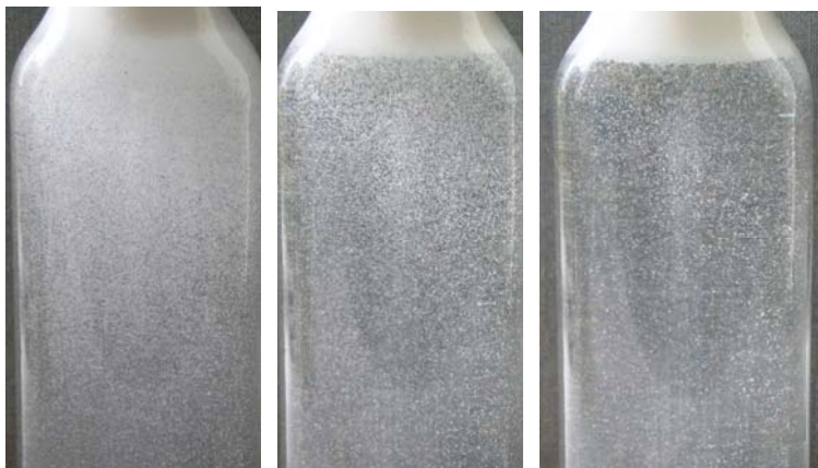
Рис. 1. Разделение микро баллонов \text{Al}_2\text{O}_3 . Кинетика всплытия, \times 1
