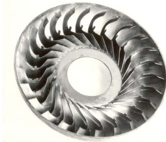
Рис. 15. Рабочее колесо гидротрансформаторов дорожных машин, полученное методом печной пайки с применением порошковых композиционных припоев
