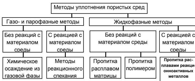
Рис. 1. Основные методы уплотнения пористых сред углеродными и керамическими матрицами
