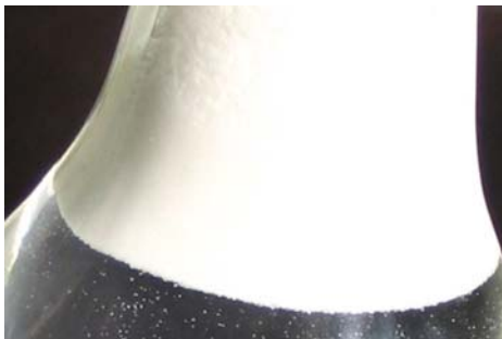
Рис. 2. Формирование образца всплывшими микро баллонами, \times 4
