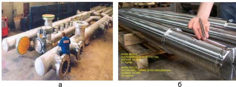
Рис.16. Промышленные продукты технологии ГИП: а - секции химических реакторов из порошков коррозионно-стойкой стали; б – прокатные валки из порошков инструментальной стали
