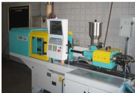
Рис.20. Универсальная машина ALLROUNDER 170 U 150 - 70 инжекционного формования пластифицированных смесей порошков керамики, металлов и сплавов
