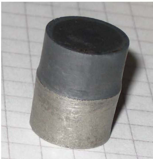
Рис. 2. Комбинированный зубок после спекания
