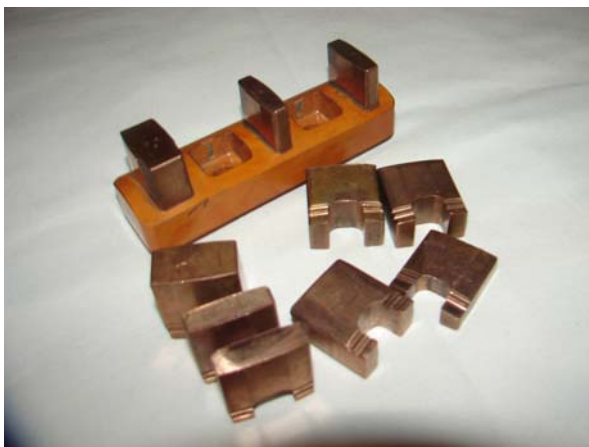
Рис. 1. Ножевые электроконтакты из порошковых композиционных материалов и ножевая колодка с залитыми в нее пластмассой ножами, устанавливаемая в электропривод СП-6М
