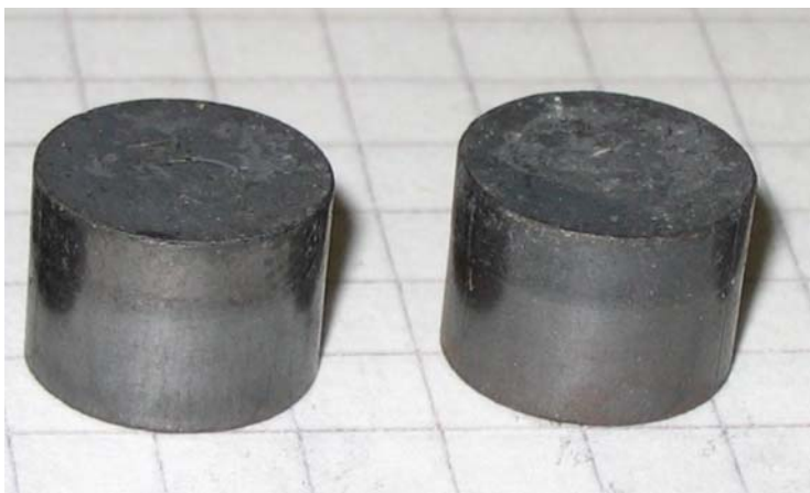
Рис. 1. Образцы после прессования: нижняя часть – никель; верхняя часть – твердый сплав
