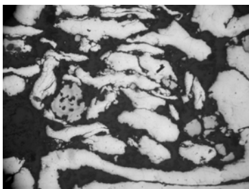
Рис. 6. Фотография структуры вспененного алюминия, \times 5
