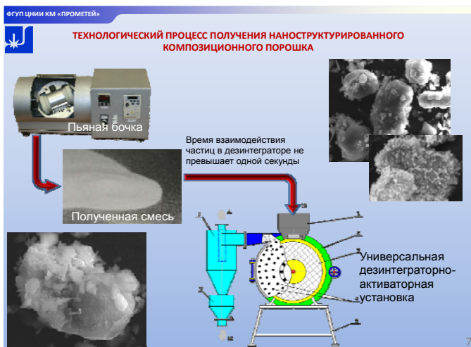
Рис.2 Процесс получения наноструктурированного композиционного порошка
