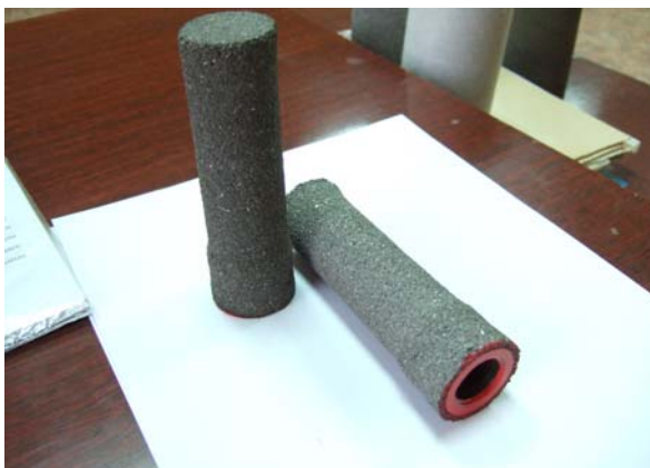
Рис. Общий вид фильтроэлементов из компактно-пористых материалов для систем химводоподготовки
