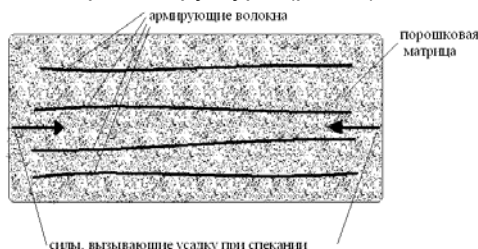
Рис. 1. Модель композиционной пористой структуры при спекании
