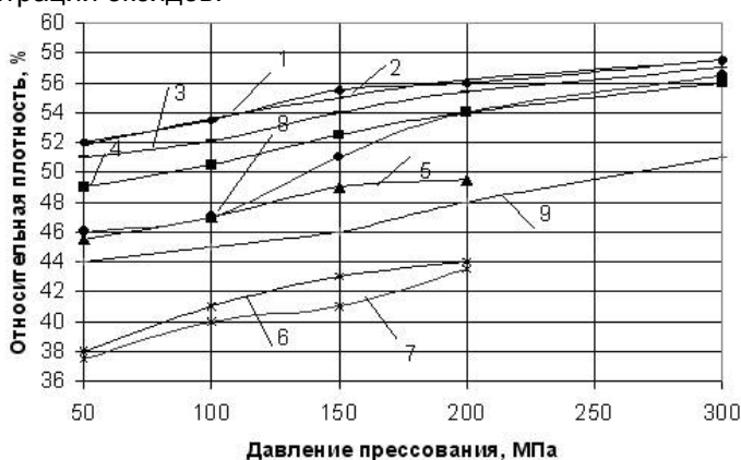
Рис. 1. Влияние давления прессования на относительную плотность образцов с добавками \text{Al}_2\text{O}_3 : — 0 мас. %; 2 — 0,5 мас. % (1); 3 — 1 мас. % (1); 4 — 2 мас. % (1); 5 — 5 мас. % (1); 6 — 10 мас. % (1); 7 — 15 мас. % (1); 8 — 2 мас. % (2); 9 — 5 мас. % (2)
