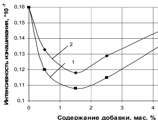
Рис. 6. Влияние добавки оксида алюминия (1) и оксида циркония (2) на износостойкость твердого сплава
