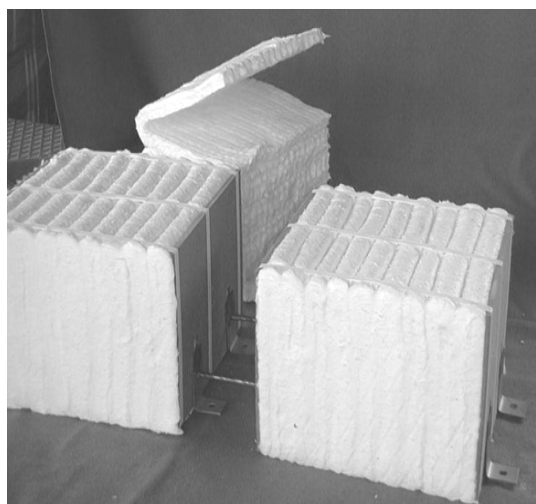
Рисунок 4 – Волокнистые модули Cerablanket, предназначенные для монтажа футеровки, и зависимость эффективной теплопроводности материала Cerablanket от плотности: синие маркеры – результаты измерений, черные – справочные данные производителя [3].
