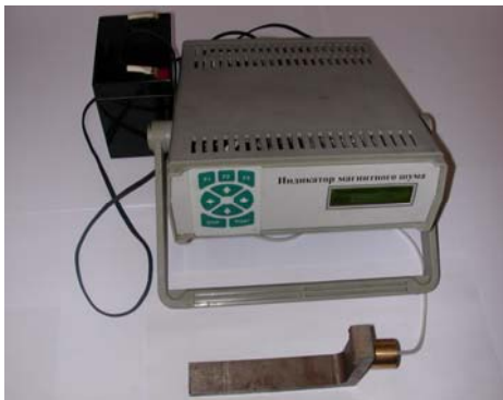
Рис. 1. Прибор ИМШ с накладным преобразователем
