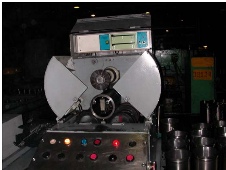
Рис. 2. Гильза блока цилиндров, установленная в отсек контроля дефектоскопа
