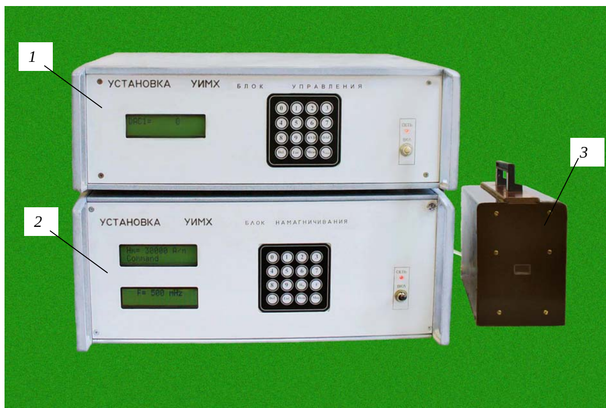
1 – блок управления; 2 – блок намагничивания; 3 – преобразователь
